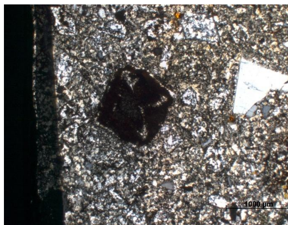
Фиг. 78. Кородиран руден минерал и отделни кварцови зърна, Nx, проявление Арката (Ar1)
