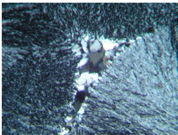
Фиг. 113. Микроахат с кварцово ядро и CH-wL халцедон, Nx , проявление Момина сълза ( Ms2 ) ширина 1.04 mm
