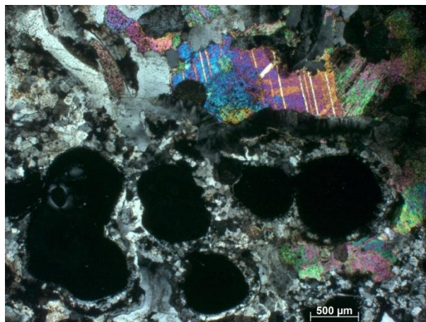
Фиг. 163. Калцит и овални рудни минерали сред кварцова основна маса, Nx, проявление Звездел (Zv1)
