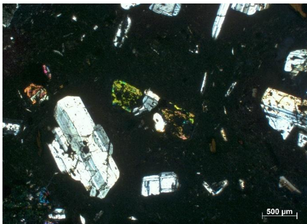
Фиг. 134. Скалообразуващи минерали (Pl, Amp, Bt) и основна маса във вместващата скала, Nx, проявление Неофит Бозвелиево (Ne3)
