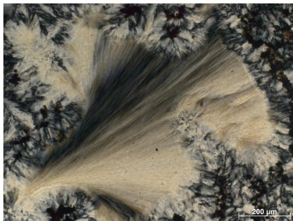
Фиг. 96. Параболичноvlakнест халцедон сред основна маса от същия структурен тип с по-дребни размери, Nx, проявление Чуково (Ch3a)
