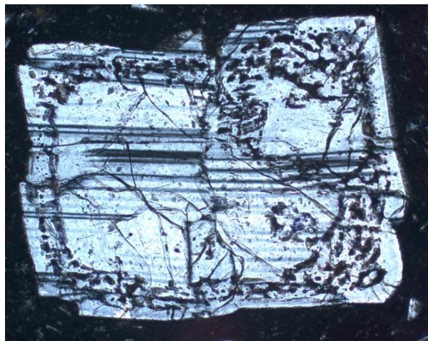
Фиг. 155. Зонален плагиоклаз с капковидни включения, Nx, проявление Пазарци (Pa1)
