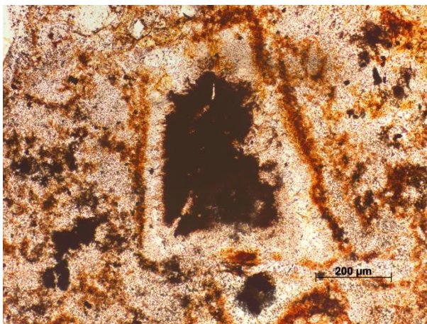
Фиг. 79. Руден минерал инкрустиран с кварц и пигмент, NII, проявление Арката (Ar1)
