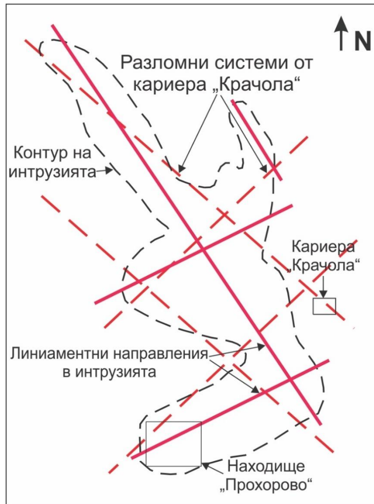
Фигура 10.3. Фигура с наложени върху очертанията на кварц-диоритовата интрузия от фиг. 10.1. а) разломните системи установени в кариера „Крачола“ (с червени пунктирани линии), линеаментните направления, които интрузията формира (червени непрекъснати линии) и местоположенията на находище „Прохорово“ и на кариера „Крачола“ в която са проведени изследванията.
