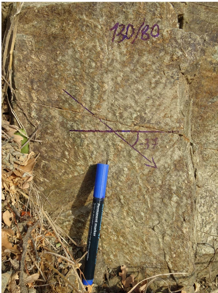
Фигура 8.9. Фотография на разломна стена с посока и наклон съответно 130^\circ и 80^\circ . Направлението на преместването по нея склучва ъгъл с хоризонтала -37^\circ по конвенцията на Аки-Ричардс (Aki, Richards, 1980) (сн. Д. Страхилев).
