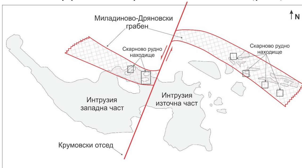
Фигура 10.6. Скица на разкриващите се на повърхността части на Манастирския плутон-западна част, източна част и малки тела. На скицата с червена шриховка е изобразен Миладиново-Дряновския грабен. С червена непрекъсната линия е означено положението на Крумовският отсед, който размества, както инtruзията, така и грабена. С черни полигони са показани местоположенията на скарновите рудни находища.
